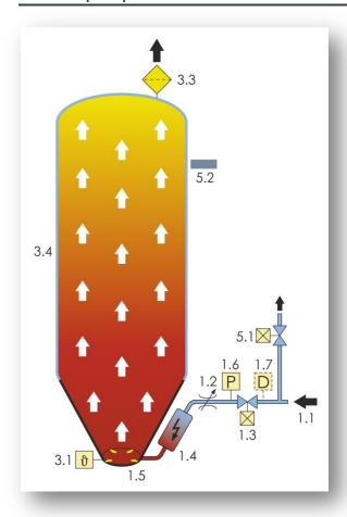
Druckluft wird über einen Steck-Fix Anschluss (1.1) zum Magnetventil (1.3) und Druckregler (1.2) geleitet. Die expandierende und dadurch sehr trockene Luft strömt weiter in die Heizung (1.4), wird dort auf Trocknungstemperatur aufgeheizt und gelangt über den Verteilerring (1.5) in den Trocknungsbehälter ganz unten. Dort angekommen steigt sie von unten nach oben, erwärmt und entfeuchtet dabei das zu trocknende Granulat und entweicht schließlich über den Luftaustrittsfilter (3.3) in die Umgebung.
